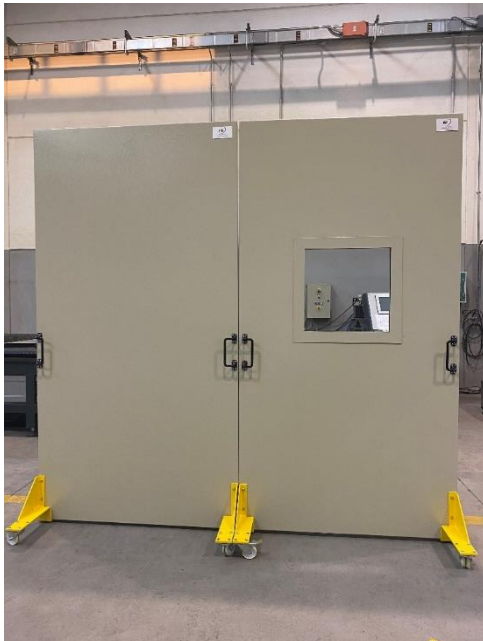
Prestazioni della barriera misurate in ambiente di lavoro. Dimensioni della barriera: 1300xH2500mm. Misura effettuata a 1m di distanza
